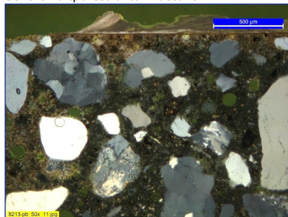
Overfladen af betonen er karbonatiseret fra 0,2 til 0,8mm. Der ses kalkskallede begrøninger på betonens overflade. X-polariseret lys.
