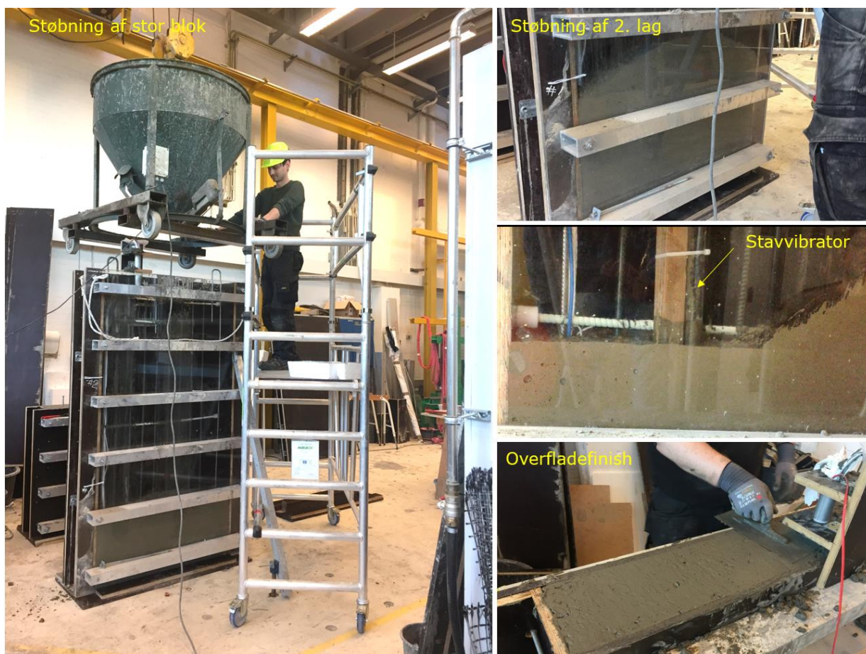
Figur 8. Billeder fra støbning af en stor blok. Der støbes med transparent formside.
