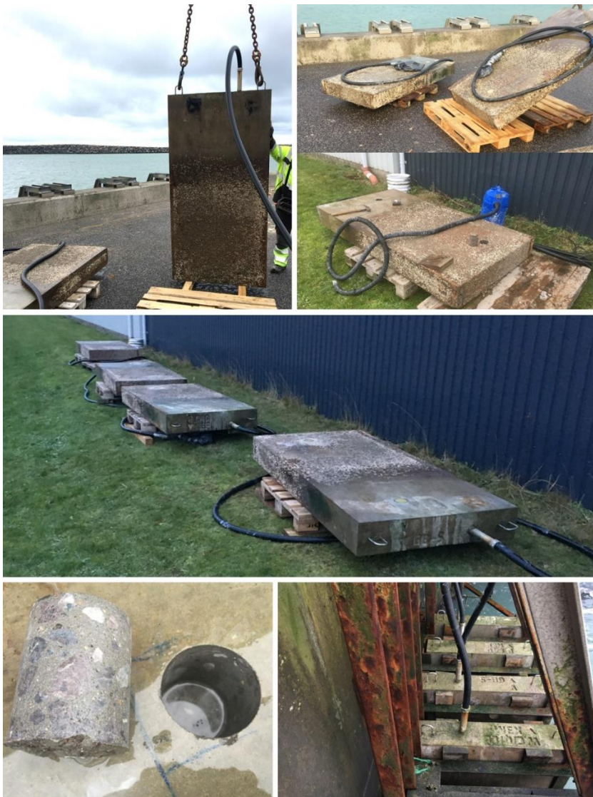
Figur 15. Udtagning af borekerner fra de fire blokke i Hirtshals havn efter ca. 1 års eksponering. P: Reference, R: GB-3, V: GB-5 og W: X3M.
