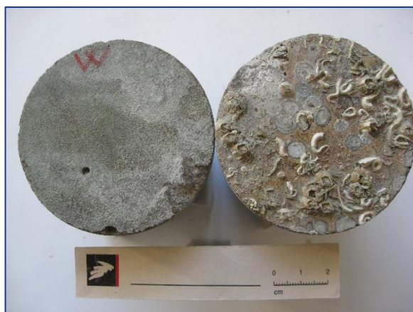
Til venstre ses overfladen af kernen udtaget over vand; til højre undervand.
