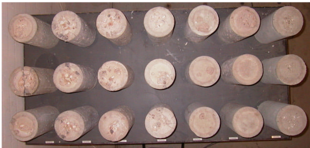
Figur 3.4. Foto af de afprøvede betoncylindre med P-betoner. I første venstre søjle ses 3 cylinder med betontype PR dernæst P2, P3, P5, P6, P7 og DTU.
