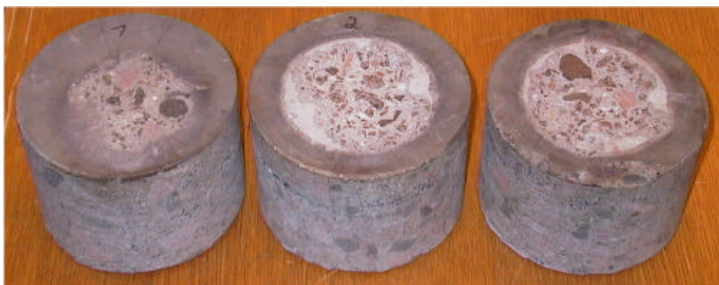
Figur 2.16. Foto af de 3 afprøvede borekærner Ø 143 mm x 100 mm fra flise nr. 9.
