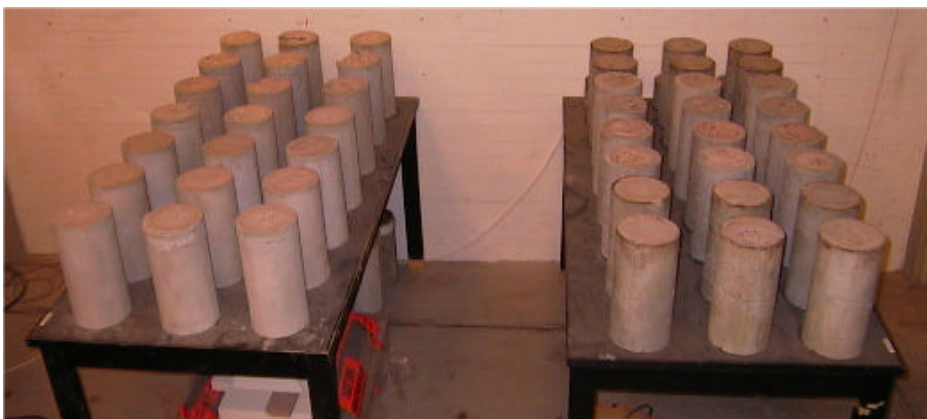
Figur 3.2. Oversigtsfoto af brandprøvede betoncylindre. Cylindre med P-beton på venstre bord og A-beton på højre.
