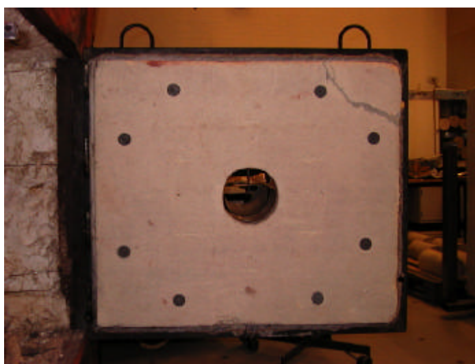
Figur 2.2. Foto af ny ovnlåge set fra bagsiden med isolering (hvid) og 8 stålskiver.
