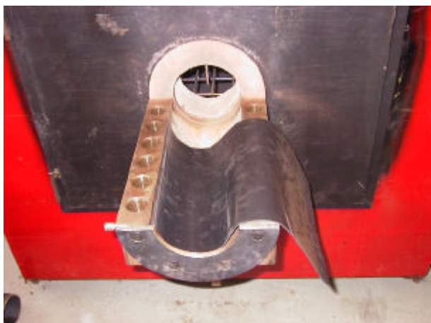
Figur 5.6. Foto af underdel af stålkappe med ilagt trykfordelingsmateriale.
