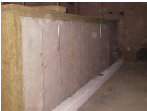
Figur 4.9. Foto af vægelementer før brandprøvning med isolering på de korte sider. Der ses lodrette stålrør inde holdende termoelementer til måling af temperatur i ovn. Termoelementerne er placeret ca. 5 – 10 cm fra betonoverfladerne.
