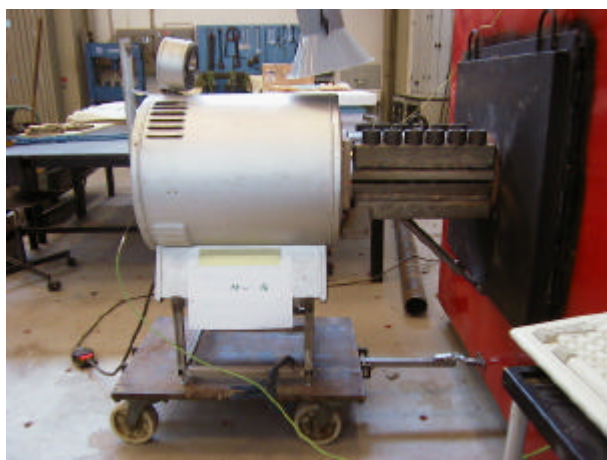
Figur 5.2. Foto af opstilling til forsøg for eksplosiv afskalning.
