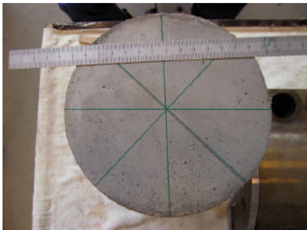
Figur 5.4. Foto af opmåling af cylinder.
