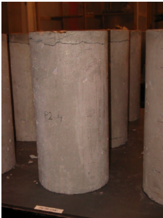
Figur 3.8. Foto af cylindre med revnetype c) "Tophat".
