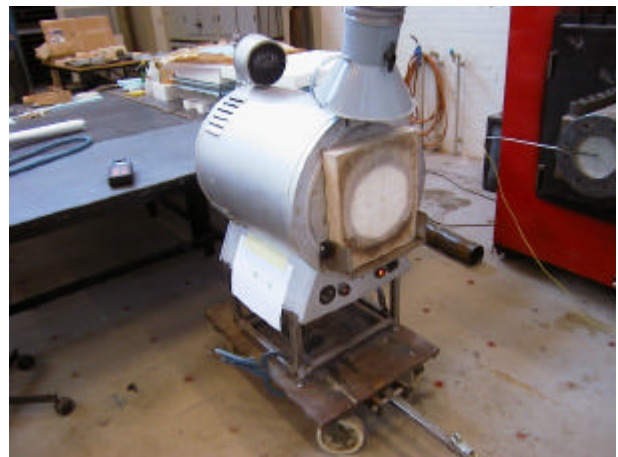
Figur 5.13. Lille ovn under opvarmning. Bemærk isoleringsskot (isolering med rundt hvidt område) som anvendes under opvarmning af ovn.
