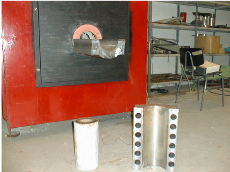
Figur 2.8. Foto af ovnlåge med fastmonteret nederste stålkappehalvdel samt på gulv øverste stålkappehalvdel og afprøvet betoncylinder.
