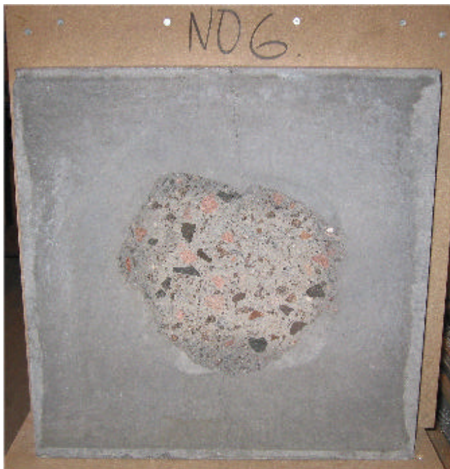
Figur 1.1. Foto af brandprøvet flise nummer 6 fra afgangprojektet [3]. En trækrevne, øverst midt for og ned til afskallet område, kan anes.
