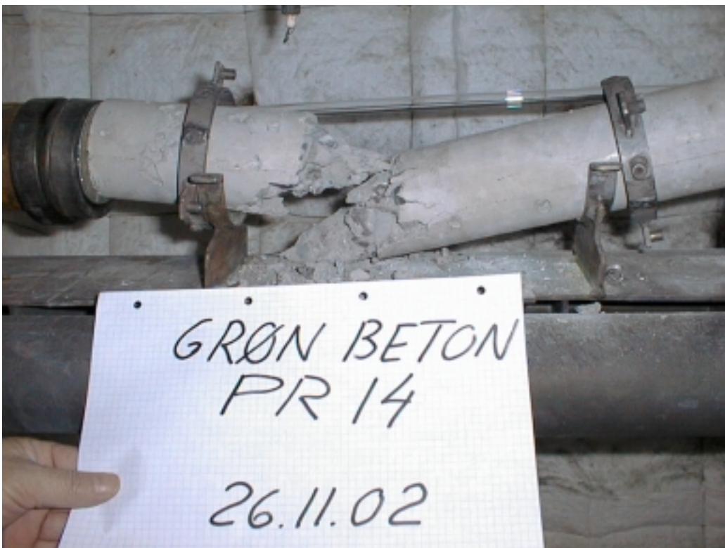
Fig. J.4: Prøveemne PR-14 efter afkøling. Brud skete under konstant trykspænding på ca. 17 MPa ved en temperatur på ca. 340 °C.
