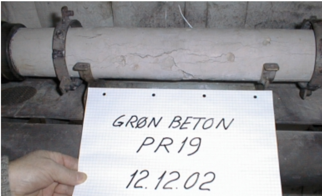
Fig. J.5: Prøveemne PR-19 efter afkøling fra ca. 550 °C under fastholdt deformationsforsøg.
