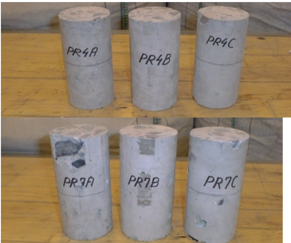
Fig. J.6: Prøveemne PR-4 og PR-7 efter afkøling fra hhv. 200 og 400 °C. Savet op i 3 cylindre til bestemmelse af resttrykstyrker.
