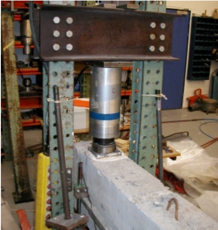
Figur 5: Højre bjælkeende med donkraft virkende nedad.
