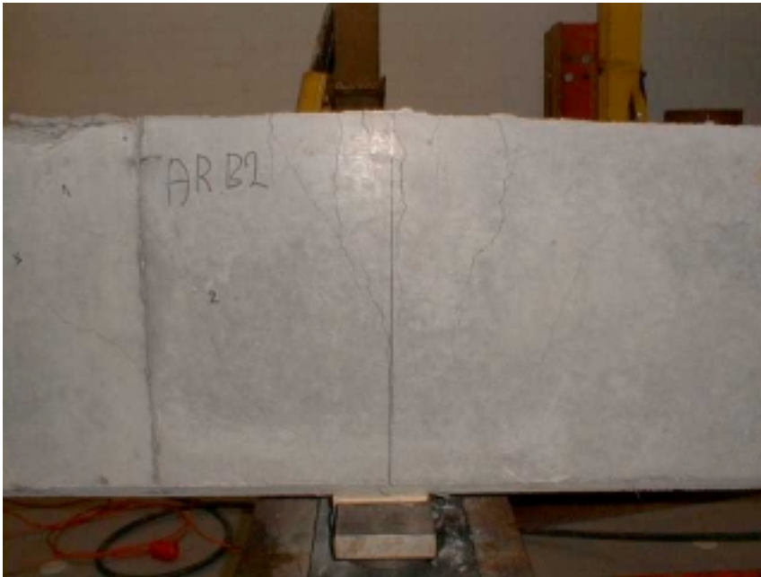
Figur B-1: Bjælke AR-b2 efter bøjningsbrud over understøtningspunkt.
